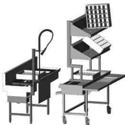
La parte frontal del sistema está diseñado de forma móvil, lo cuál hace la limpieza de parte trasera (cuba y sistema de arraste de cestas) más fácil.
